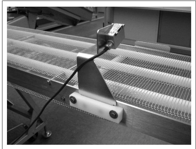
Fig. 99: Remove light sensor
