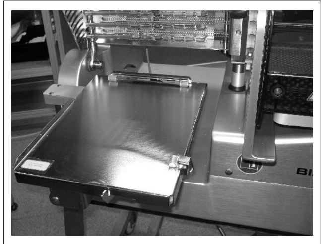
Fig. 98: Remove depositing table
