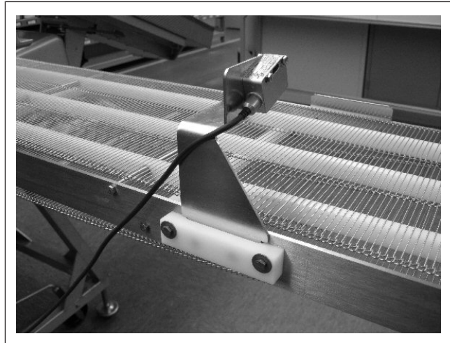
Fig. 89: Remove light sensor
