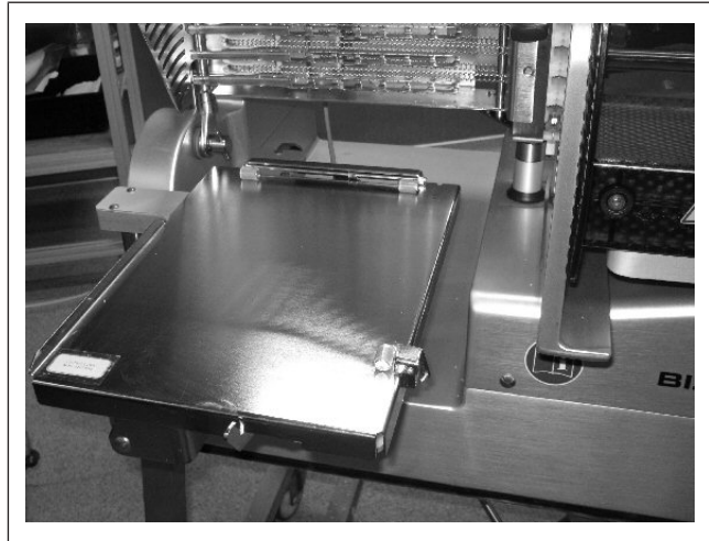
Fig. 88: Remove depositing table
