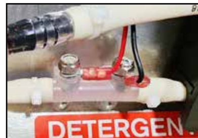
Fig. 31 - If equipped, in-line sensor
