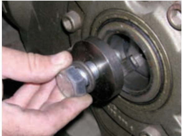
3. Remove shaft retaining bolt.
