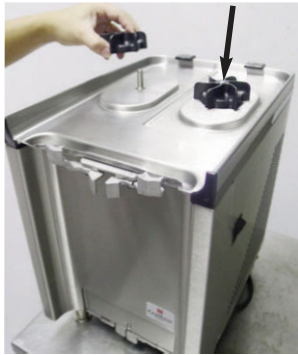
Mettre en place l'agitateur.
