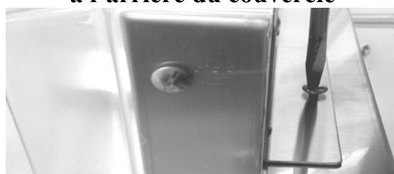
Installer la vis de sécurité à l'arrière du couvercle
