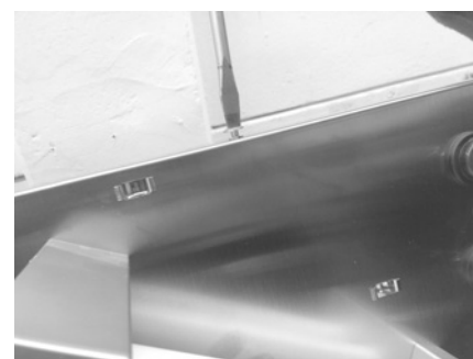
Enlever la vis de sécurité sur le dessus de l'appareil
