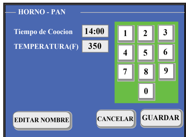
Figura 6: Pantalla de modificación de recetas del horno
