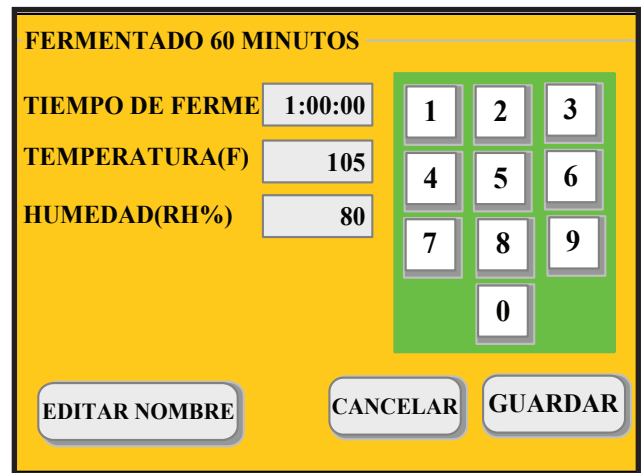
FIGURA 15: Pantalla de modificación de recetas de la fermentadora
