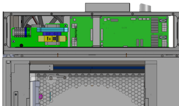
Abbildung 3: Ansicht Elektroraum bei entfernter Blende
