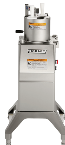
Accessoire de 4 tubes de chargement sur base
