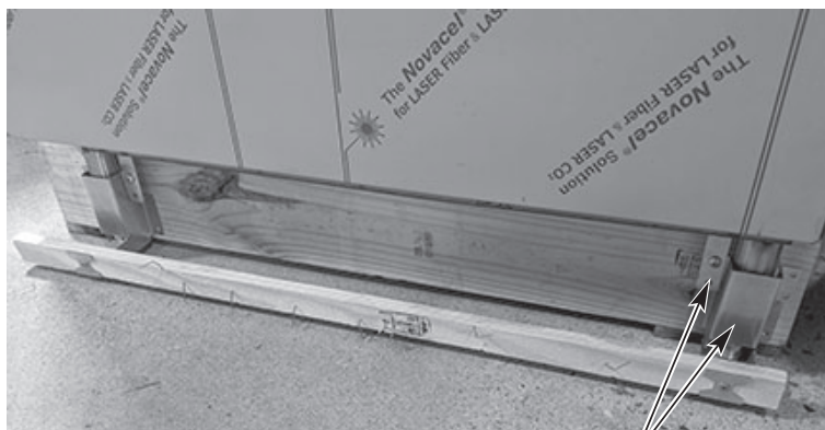
RETIRE LOS SOPORTES DE ENVÍO (4 LUGARES)
