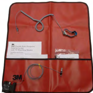
Ejemplo de kit de conexión a tierra 3M 8507 con alarma audible
