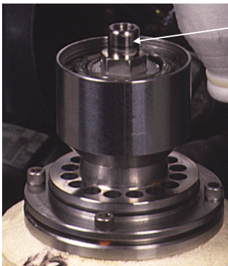
4. Destornille el soporte del gusano.
