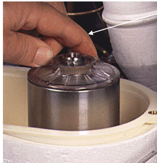
3. Quitar la tapa de agua y destornille la tapa del breaker.
