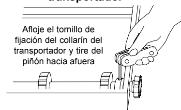
Figura 2-8 - Remoción de la rueda dentada motriz del transportador
