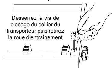
Figure 2-8 - Dépose de la roue d'entraînement du transporteur
