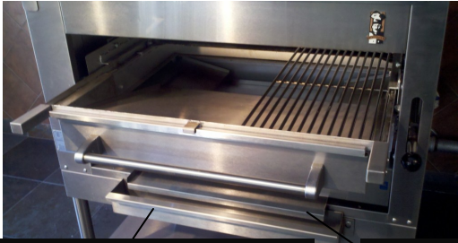
Concentrador de grasa horizontal
