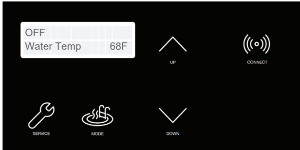
Figure 106. Réinitialisation Wi-Fi – Appuyez sur CONNECT
