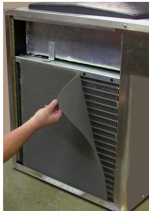
Fig. 3-11 Retiro del filtro condensador, modelo F112
