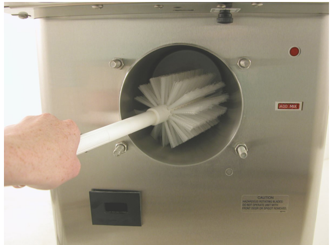
Figure 3-7 Nettoyage du Cylindre de Congélation
