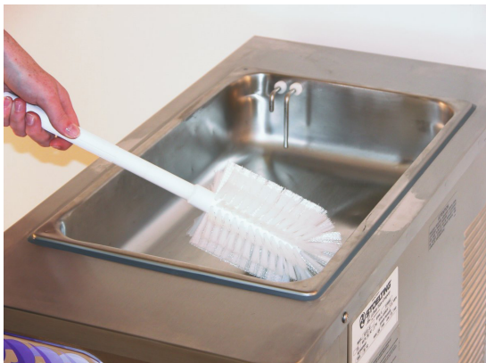
Figura 3-3 Higienización del depósito
