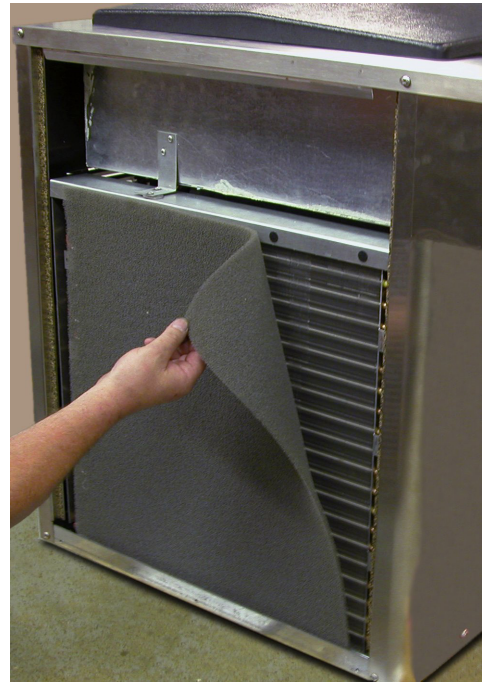
Figure 3-11 F112 Enlèvement du Filtre du Condenseur
