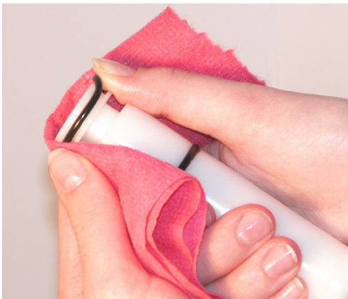
Figura 3-6 Retiro de la junta tórica
