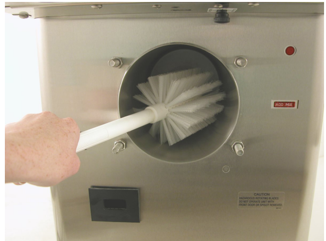
Figure 3-7 Nettoyage du Cylindre de Congélation
