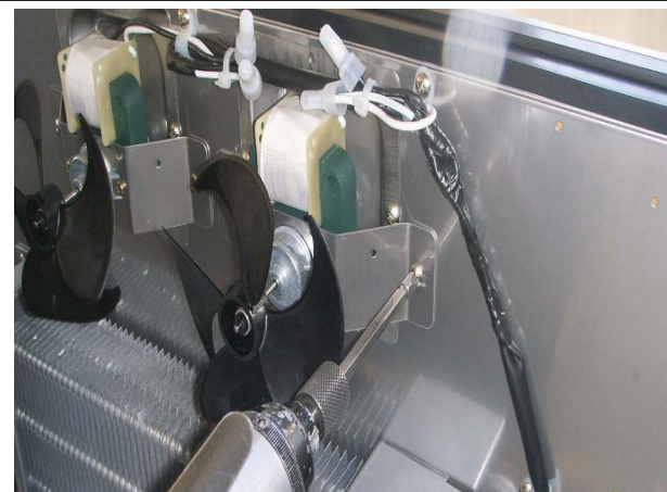
B. Remove the evaporator fan motor
