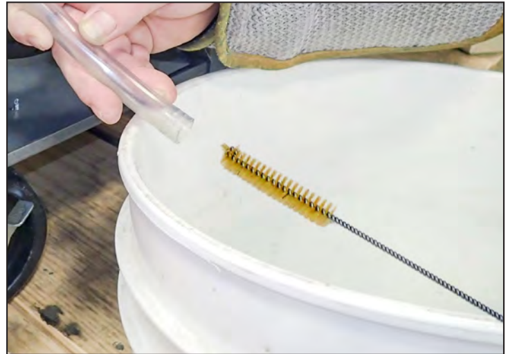
Fig. 2. Recoja el líquido retenido en un recipiente grande.
