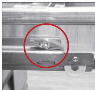
Fig. 5. Ubicación del retén del cajón. El retén está enganchado.
