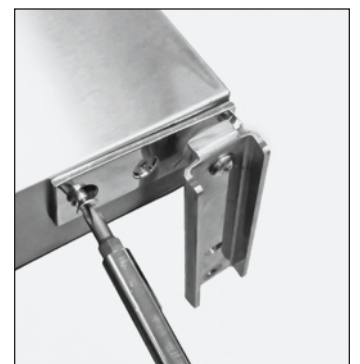
Fig. 5. Retire el módulo de bisagra de cartucho.
