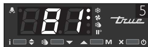
Imagen 4. Si la palabra "yes" aparece en la pantalla, el controlador está bloqueado
