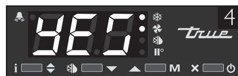
Imagen 4. Si la palabra "yes" aparece en la pantalla, el controlador está bloqueado
